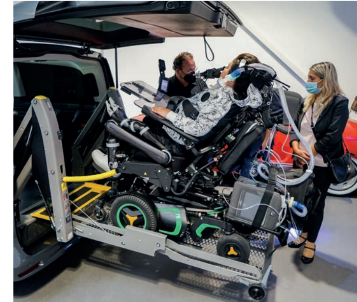
Hecklift mit einer maximalen Traglast von bis zu 400 kg
