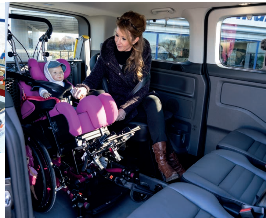
Mitwachsender Dreh-Schwenksitz mit Pelotten, 4-Punkt-Gurt uvm.
