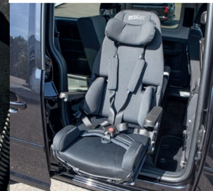
Mitwachsender Dreh-Schwenksitz mit Pelotten, 4-Punkt-Gurt uvm.
