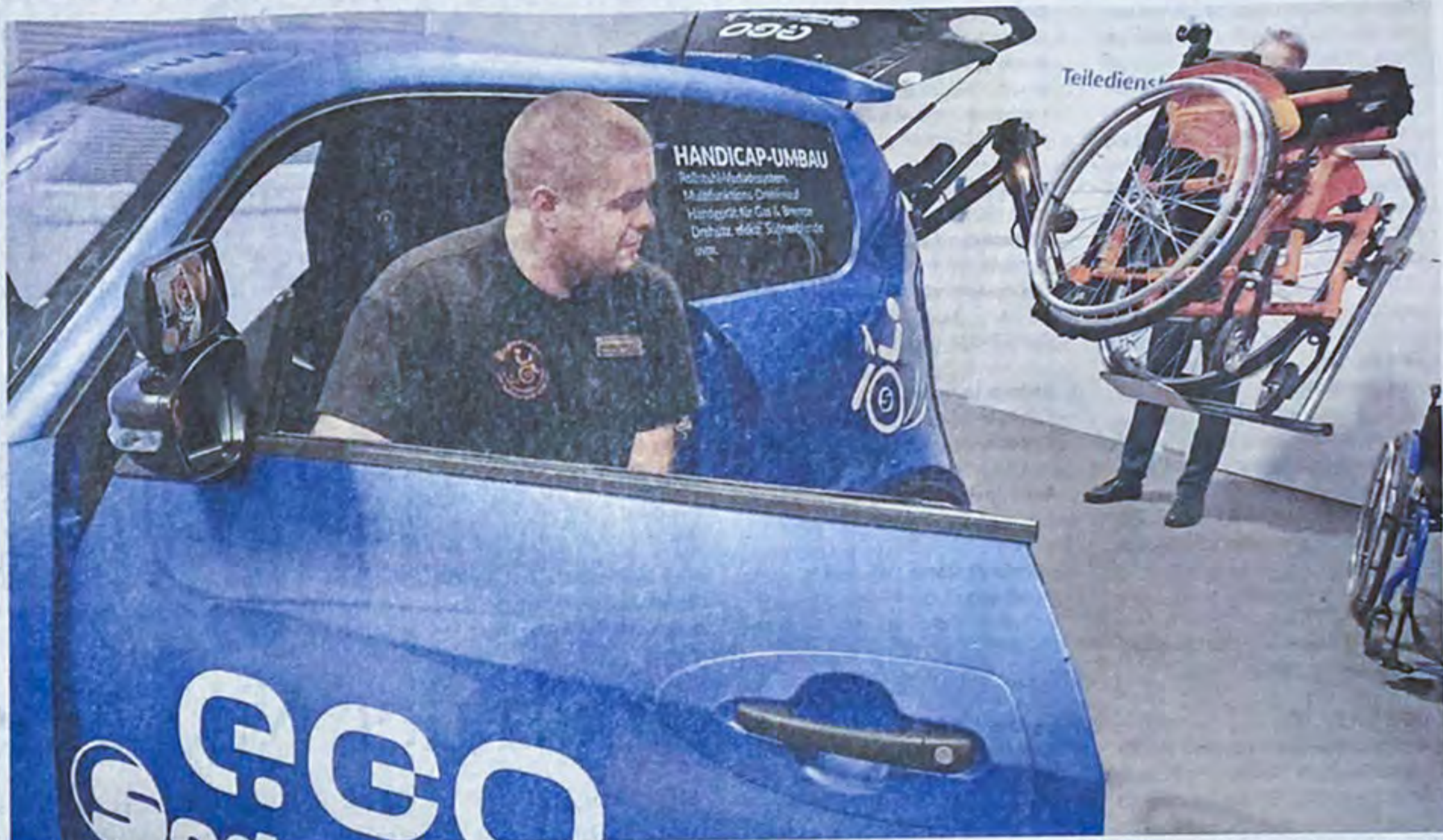
Der Rollstuhl wird per Roboterarm neben den Fahrersitz gestellt. Ein solches System ist noch nie in einem so kleinen E-Auto untergebracht worden.
